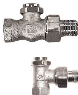
RL5 radiator forskrunding m/forindstilling, afsp. & tøm/fyld funktion
