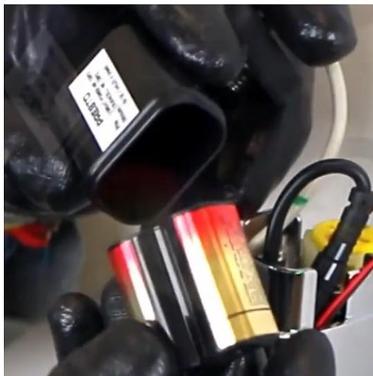
Fermer le couvercle du boîtier pile et reposer le capot
